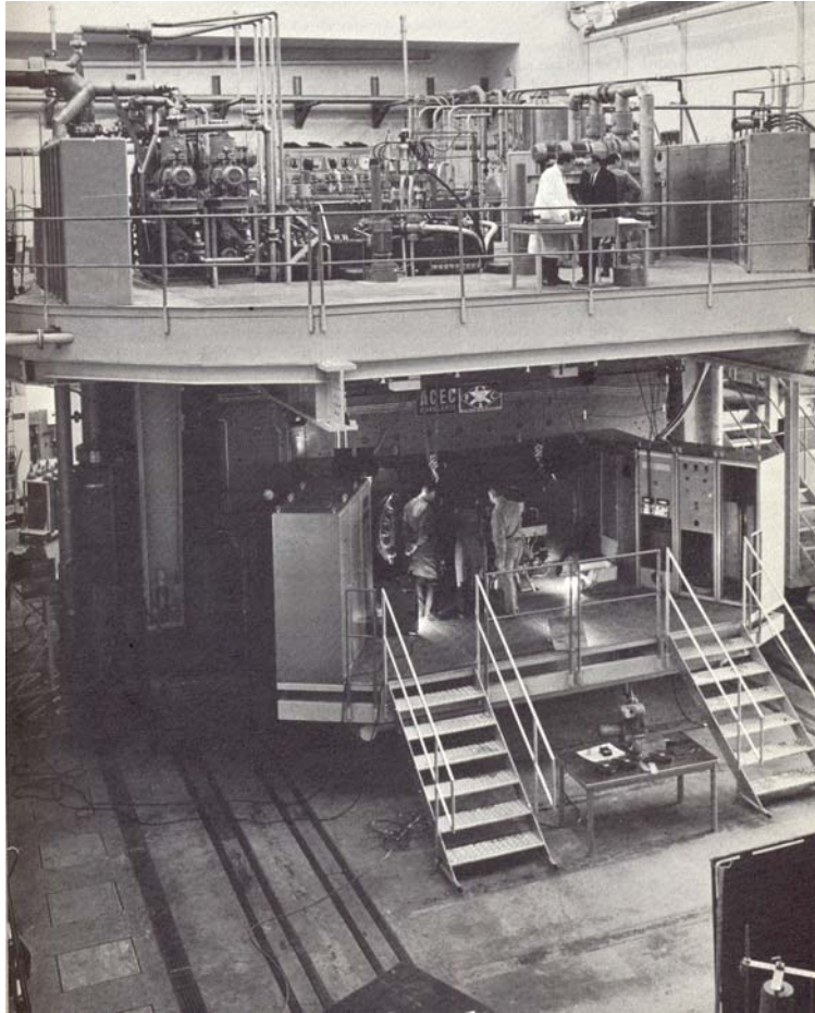
Het 2m bellenvat (opgebouwd binnenin magneetjuk)
