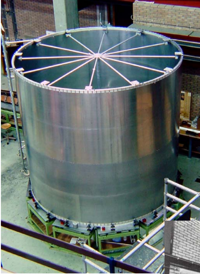
Cylinder voor ondersteuning van barrel Rich DELPHI
