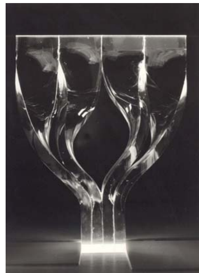
Lichtgeleider voor scintillatietellers gebogen uit plexiglas
