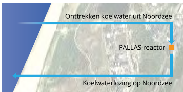
Figuur 18 Schematische weergave Koelingsvariant K2
