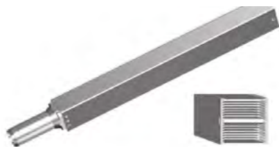
Figuur 1 Voorbeeld van een splijststofelement van een onderzoeksreactor (zijaanzicht van het hele element en bovenaanzicht waarbij de splijststofplaten zichtbaar zijn)
