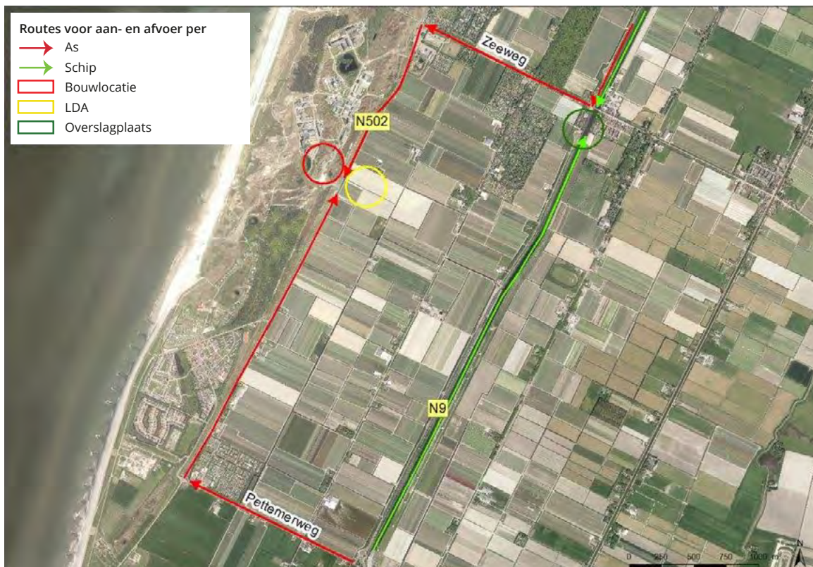
Figuur 68 Routes voor aan- en afvoer per as (rood) en schip (groen). De overslagplaats, bouwlocatie en werkterrein zijn aangegeven met respectievelijk een groene, rode en gele cirkel
