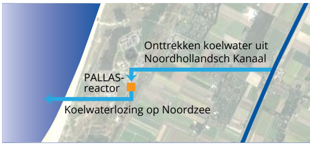
Figuur 14 Schematische weergave Koelingsvariant K1
