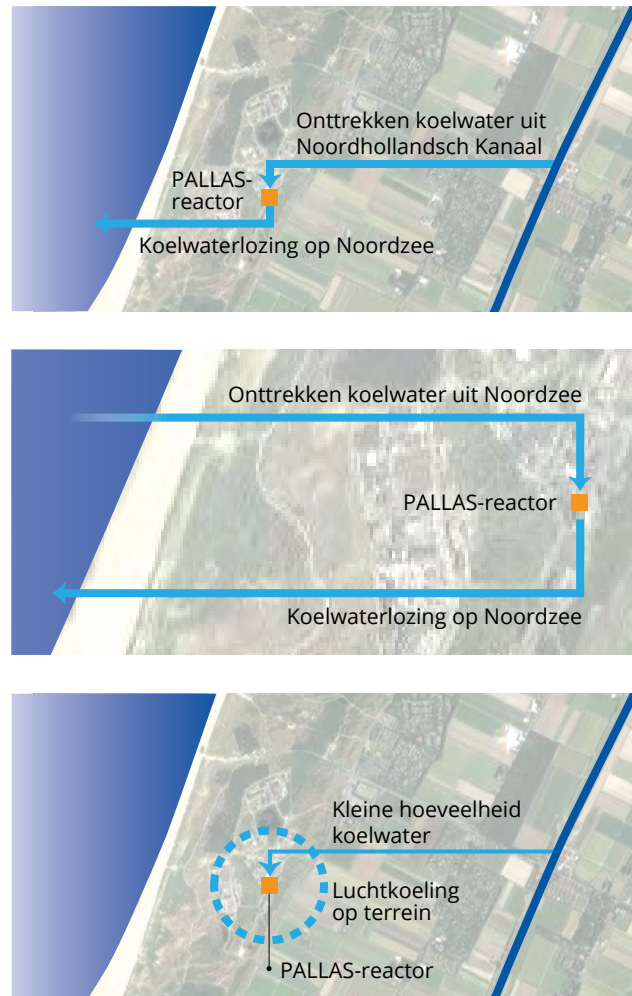
Figuur 3 Schematische weergave koelingsvarianten K1 (boven), K2 (midden) en K3 (onder)
