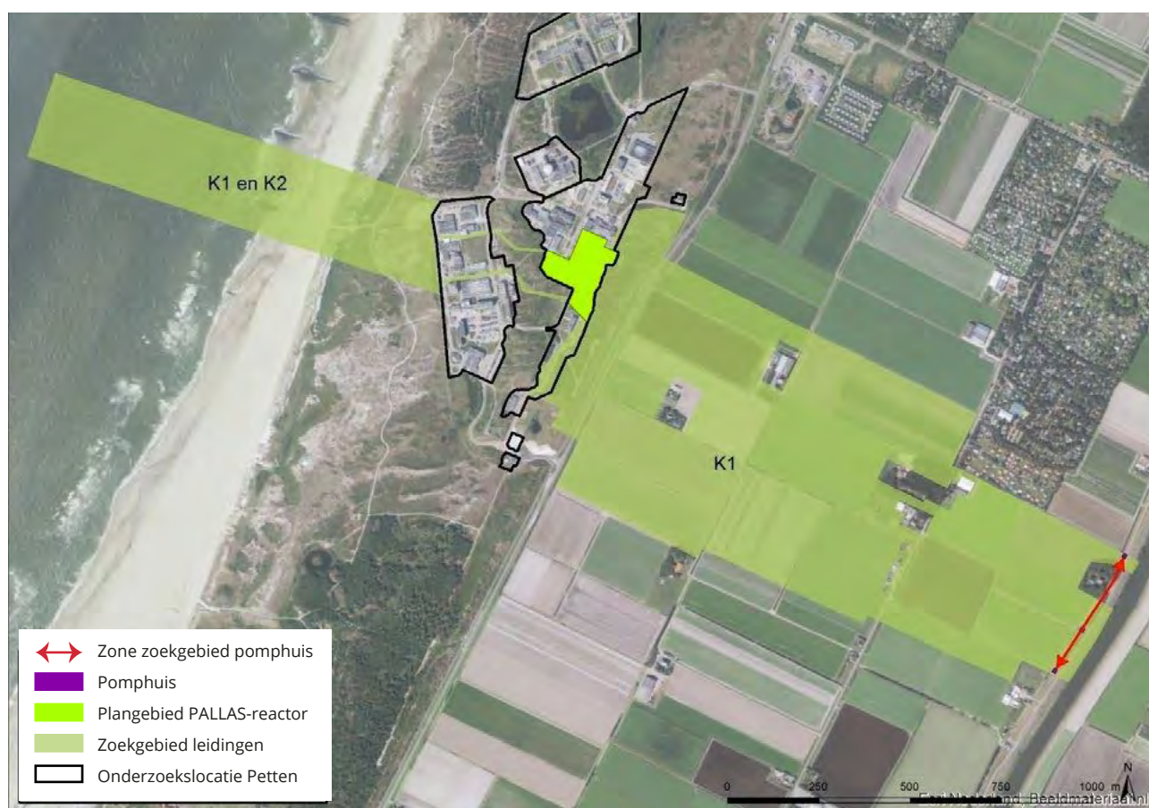
Figuur 23 Zoekgebied koelwaterleidingen tracé en beoogde ligging PALLAS-reactor
