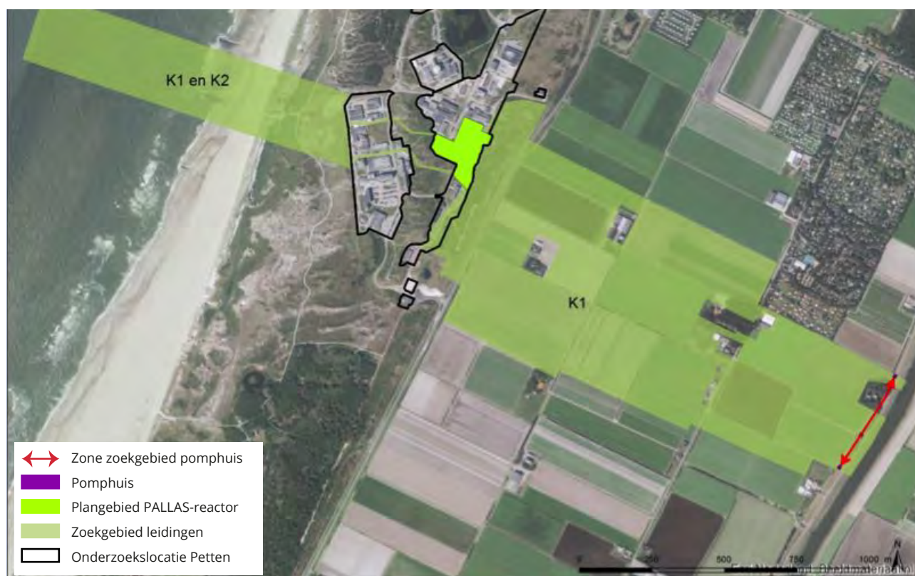
Figuur 13 Zoekgebied koelwaterleidingen tracé en beoogde ligging nieuwe reactor (groen)
