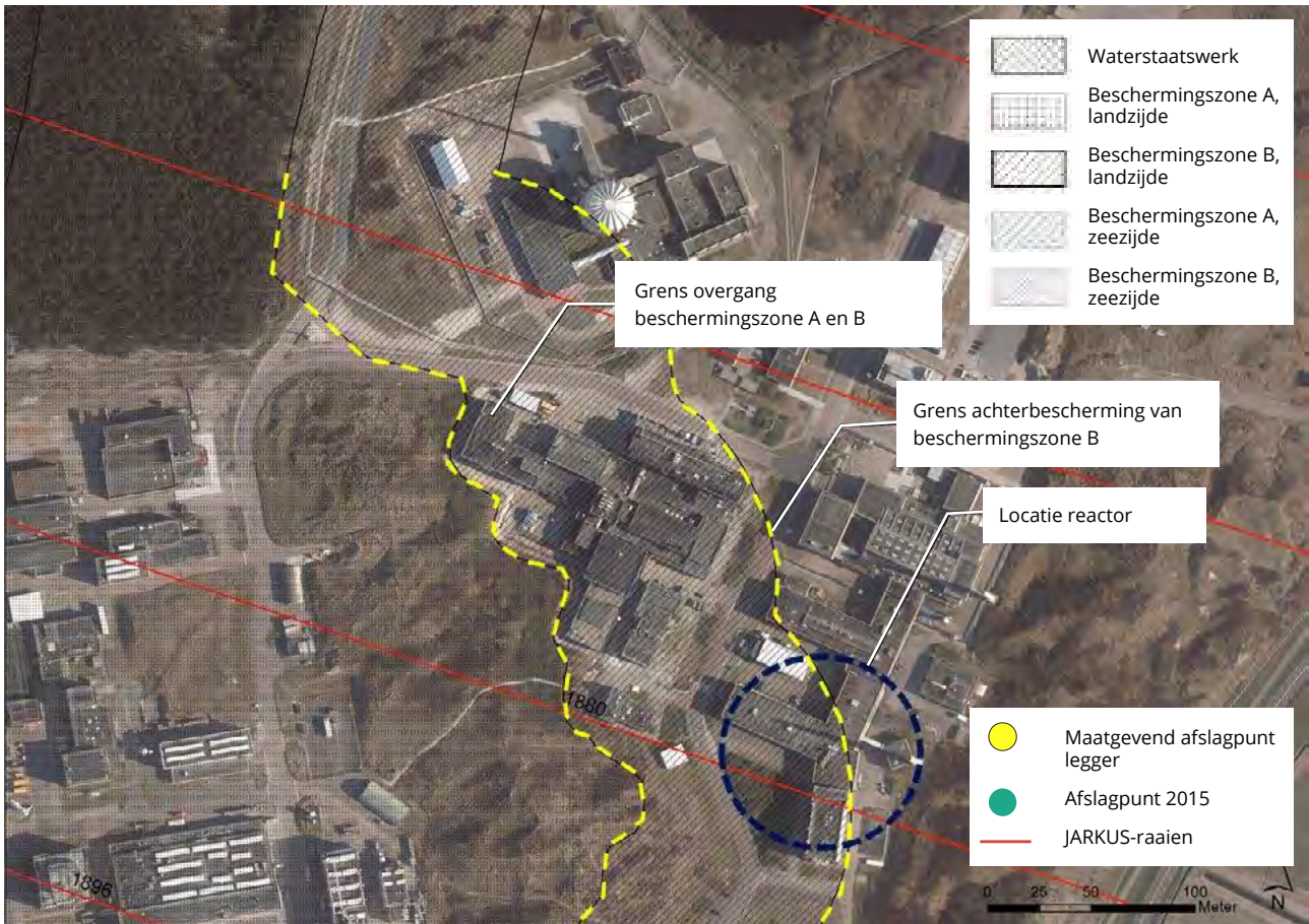
Figuur 18 Detail positie PALLAS-reactor ten opzichte van de leggerzonering waarbij te zien is dat de constructie is gelegen in de binnenbeschermingszone B (landzijde) op grote afstand van het waterstaatswerk
