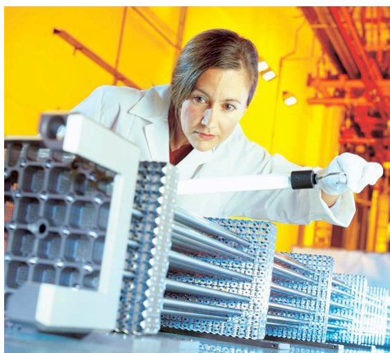
Figuur 4.2 Inspectie van een splijtstofskelet (foto: AREVA NP)
