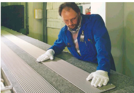
Figuur 4.1 Controle van splijtstofstaven in de splijtstoffabriek (foto: AREVA NP)
