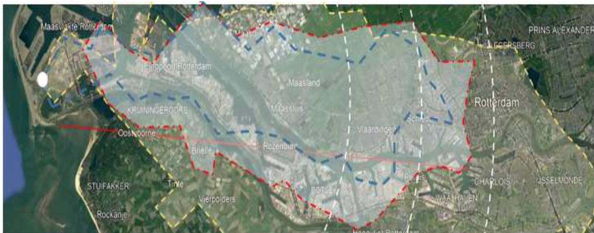
Figuur B2: Stralingscontouren Fukushima geprojecteerd op het Rotterdamse havengebied voor een 1.600 MWe centrale op de Maasvlakte (witte stip). 87
